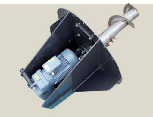
Zusatzschnecke für Rondomatknoten – erforderlich bei Substratlängen über 50 mm bzw. bei nicht rieselfähigem Material
