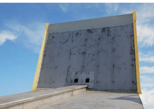
Schiebeboden und Schiebewand in V2A mit PU-Dichtleisten
