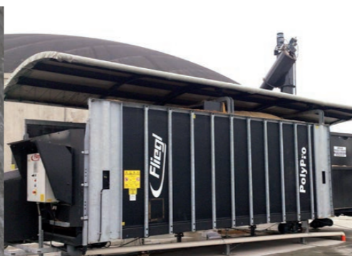
Dachkonstruktion hydraulisch klappbar
