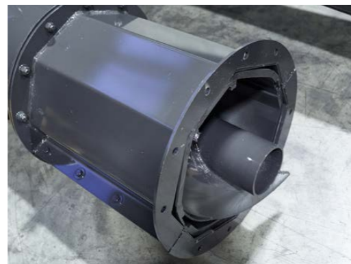
Schneckenförderrohr mit PE-Halbschalen
