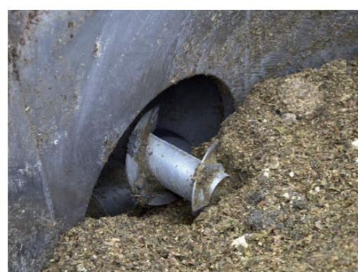
Zusatzschnecke für Rondomatknoten – erforderlich bei Substratlängen über 50 mm bzw. bei nicht rieselfähigem Material
